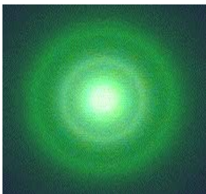
Beugungsbild eines Elektronenstrahls an Graphit.
